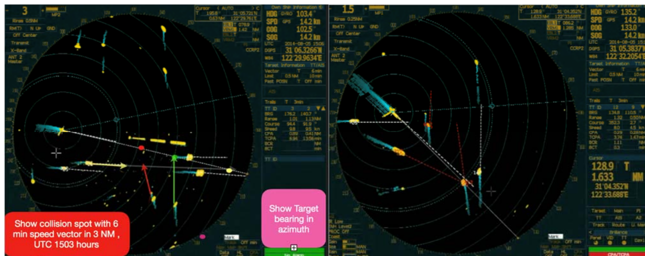
圖形 4-06 讀出可能的碰撞位置在 2306 時與 2315 時
