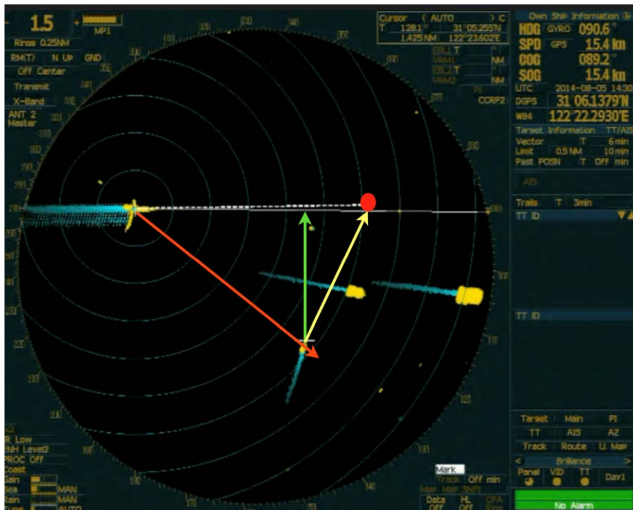
圖形 4-11 正橫距離，在改變航向之後
